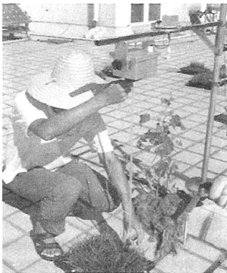
图 8 植物叶绿素、NDVI 集成测量仪
